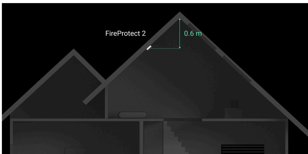
Nous ne recommandons pas de monter le détecteur sur un mur. Une telle installation est acceptable si les poutres ou autres obstacles ne gênent pas l'installation du détecteur. Une installation murale n'est possible que si le détecteur est placé à une distance de 15 – 30 cm sous le plafond, mais plus haut que les portes.
